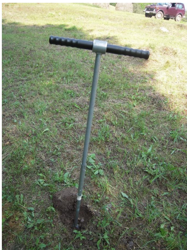
Слика 1. Сврдро са дисковима од нерђајућег челика за прикупљање узорака из доњег нивоа и композитни узорци из горњег и доњег нивоа (десно)
